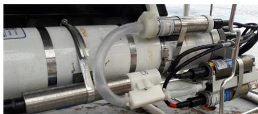
*Figure 2 : Bathysonde + Capteurs additionnels*
